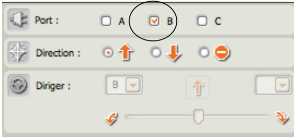
Moteur C désactivé, moteur B avance. La roue du moteur C sert de pivot et le robot tourne autour.
